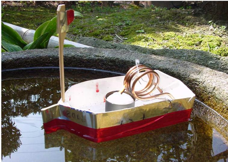
ローソクの火で銅パイプのなかの水が熱くなると、その力でポン・ポン！と船が進むよ。
