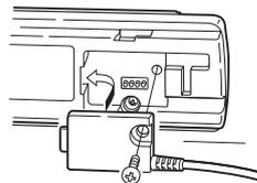
接続コネクター部の突起部をコントローラーの溝に差し込み、ネジ止めします。
