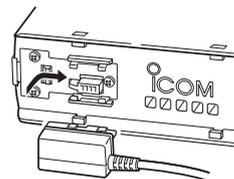
接続コネクター部の溝をツメに合わせて差し込み、右側にスライドさせます。
