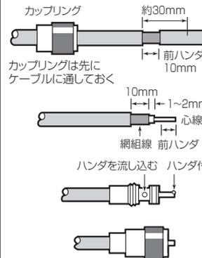
ナイフ、カッター等で外皮を切り前ハンダがしやすいように外皮を抜き取ってしまわずに、12~13mmの間をあけておく。
